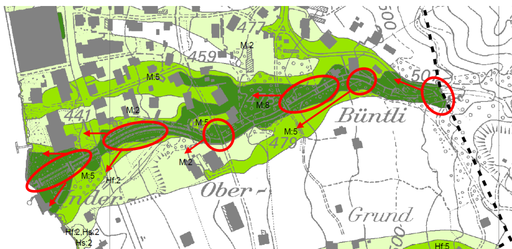
Abbildung 10: Bei 100jährigen Ereignissen kommt es entlang des Altdorfbachs auf dem Kegel an mehreren Stellen zu Übermürungen. Besonders bei Brückendurchlässen kann es zu Verklausungen und Rückstau kommen, so dass Murgänge seitlich ausbrechen.
